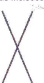
X 1 – Destacamento de até 1 mm ao longo das incisões
