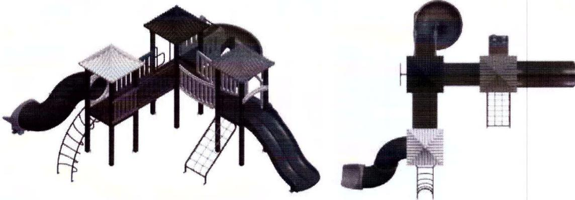
**Conjunto de Parque infantil colorido** com estrutura principal (torres) em colunas de alumínio, tendo por medidas mínima a largura de 100mmx100mm, espessura das chapas 3mm; lisas, sem cantos e reentrâncias; com no mínimo 3 reforços internos; pintura com tinta a pó de poliéster, contendo no mínimo:
