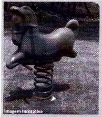
**Brinquedo infantil sobre mola, tipo cavalo**, com a seguinte descrição: Peça de plástico polietileno rotomoldado, mínimo de 300mm de largura, mínimo 900mm de comprimento e mínimo de 500mm de altura até o assento. Mola feita com aço galvanizado a fogo com Ø20mm de diâmetro, revestido com pintura eletroestática, 400mm de altura e 200mm de largura; suporte âncora feito com aço galvanizado a fogo, para fixação da mola no brinquedo e para fixação da mola dentro ou sobre o concreto ou terra.
