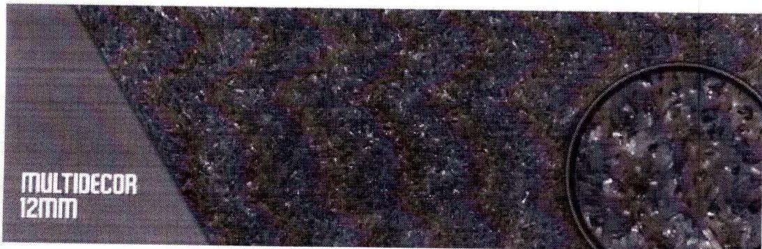
**Grama sintética** 12 mm, na cor Verde Escuro, mínimo 60.000 pontos por m<sup>2</sup>, com distância máxima entre carreiras de 5 mm, fibrilada, 100% polietileno, peso: 1,25 Kg/m<sup>2</sup>, proteção contra raios ultravioleta UV, proteção com solução antifúngica e anti-bactericida, proteção anti-chama, sendo base para instalação em contra-piso de concreto.
